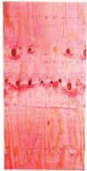
Chapa de compensado (madeirite), com espessura de 6 mm ou 10 mm, para fazer o tapume
