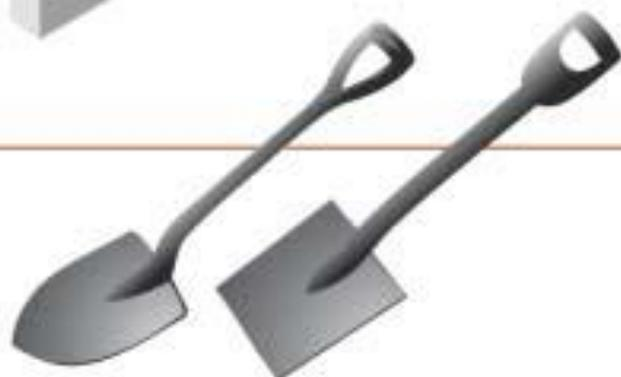
**PÁS** - Utilizadas para acerto de terreno, abertura de valas de fundação, para enchimento de lata ou carro de mão e misturas de argamassa e concreto.
