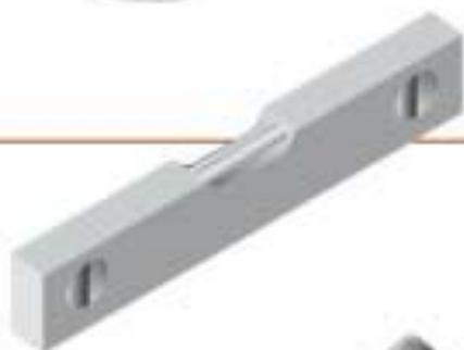
**NÍVEL DE BOLHA** - Utilizado para verificar o nivelamento (horizontal) e o prumo (vertical).
