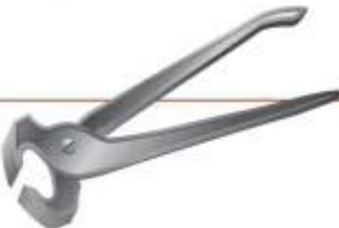
**TORQUÊS-** Utilizado para dobragem e corte de arame recozido na amarração de ferragem.
