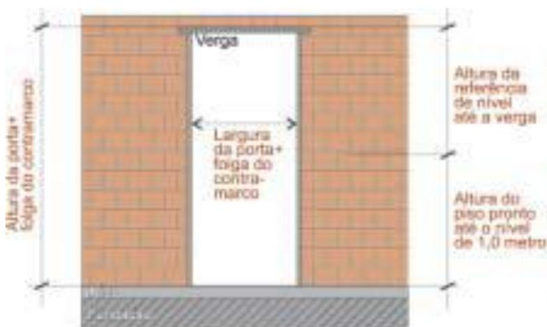
mais 20cm de cada lado transpassando a alvenaria da parede. A altura da verga é obtida utilizando-se a altura da janela, acrescentando-se a folga do contramarco conforme indicado na figura anterior. A verga é nivelada a partir da referência de nível da alvenaria que é 1.0 metros do piso pronto.
