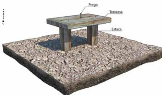
Em seguida, posicione os cavaletes na direção dos eixos onde ficarão as futuras paredes internas e externas de edificação.
